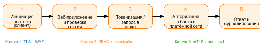
Рисунок 2. Потоки платёжных данных между веб-приложением, платёжным шлюзом и банковской инфраструктурой
